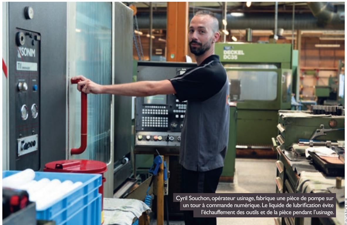
Cyril Souchon, opérateur usinage, fabrique une pièce de pompe sur un tour à commande numérique. Le liquide de lubrification évite l'échauffement des outils et de la pièce pendant l'usinage.
